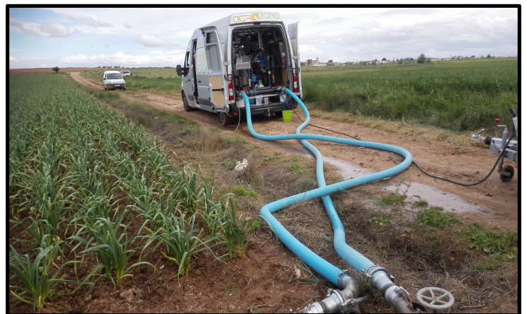
Diferentes conexiones de by pass realizadas para la adecuación de la instalación de riego a la AGRZ800.
